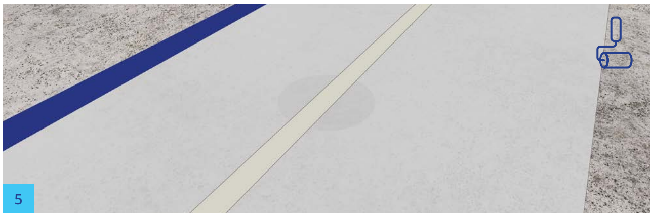
5 Nad takto zarovnanou pilotu aplikujeme folii standardním způsobem.
