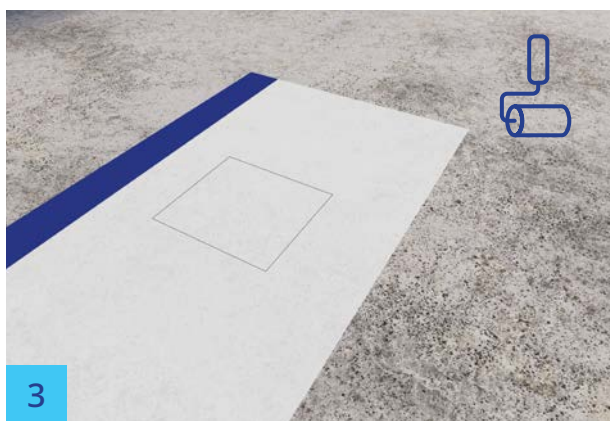
Záplata je zalepena tak, že není vidět opravná páska.
