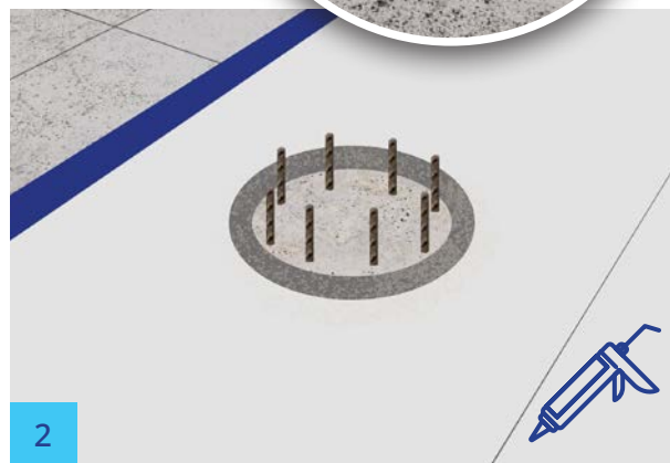
2 Obvod piloty utěsníme prostředkem Rubberflex 1K - H a posypeme křemičitým pískem.
