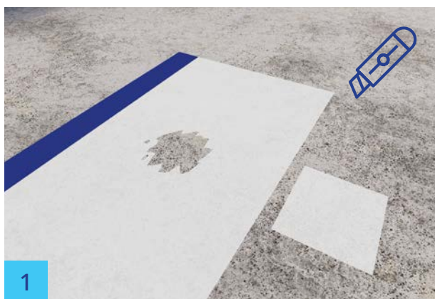
Průměr poškození větší než 1 cm.
