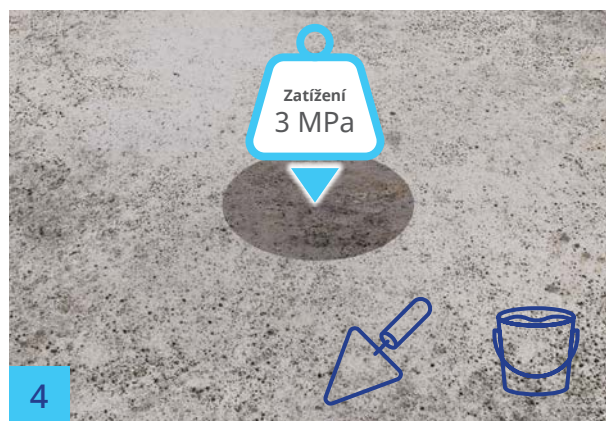
4 Před položením Hydraxu® zarovnat prostor nad pilotou betonem stejné pevnostní třídy jako je beton piloty.
